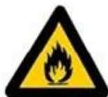
Εύφλεκτες ύλες ή/ και υψηλή θερμοκρασία
